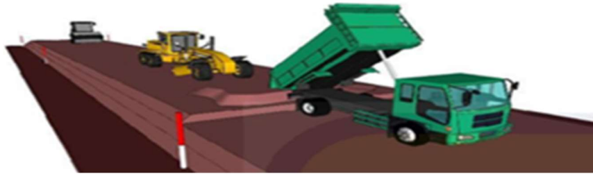
Gambar 4.9. Ilustrasi Penghamparan Tanah Timbunan
